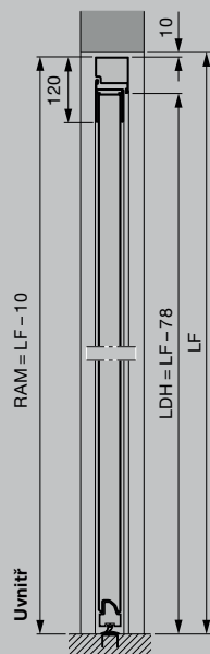
Vedlejší dveře s hliníkovou blokovou zárubní, profil typu 2 Montáž v otvoru
